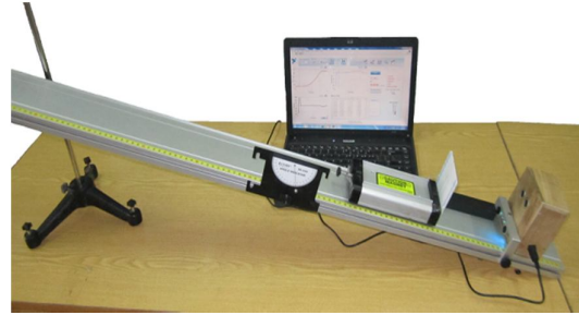
Hình 3.6. Bố trí thí nghiệm khảo sát chuyển động chậm dần đều
