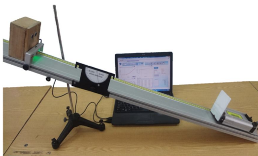
Hình 3.1. Bố trí thí nghiệm khảo sát chuyển động thẳng nhanh dần đều
