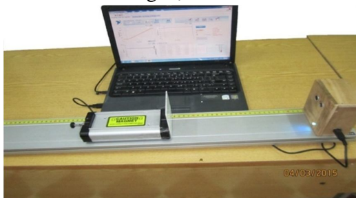
Hình 3.8. Bố trí thí nghiệm khảo sát chuyển động thẳng đều
