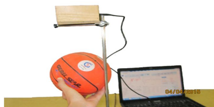
Hình 3.10. Bố trí thí nghiệm khảo sát sự rơi tự do
