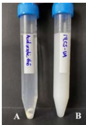
Hình 4. Độ phân tán trong nước của (A) UA dạng thô, (B) NLC-UA sau 24 giờ
