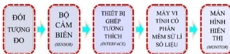
Hình 2.2. Sơ đồ hệ thống thiết bị thí nghiệm ghép nối với MVT
